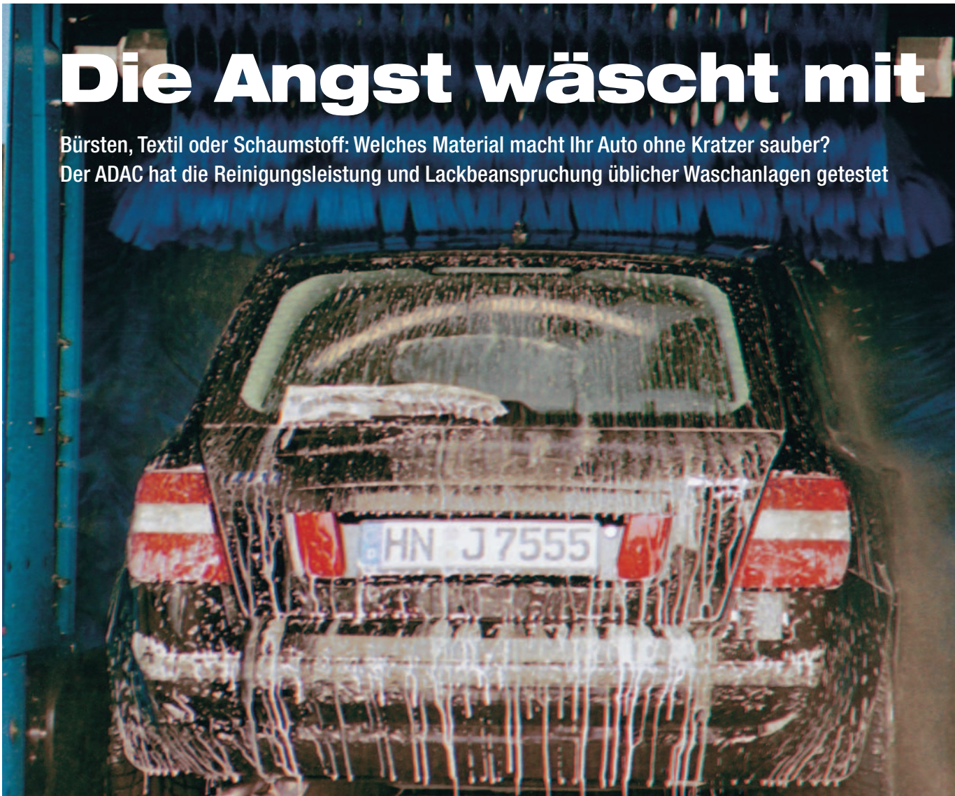
Der Fiat Stilo ist als Testfahrzeug für die Waschanlage eine harte Nuss: viele Ecken und Kanten sowie ein schwarzer Lack, der keine Schwächen verzeiht
