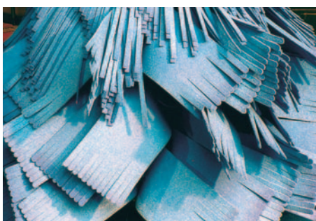
Im Textilgewebe können Schmutzpartikel hängen bleiben und kratzen, wenn sie über den Lack gezogen werden
