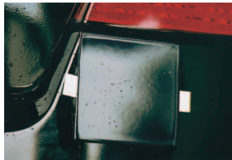
Die Prüffleche – hier eines am Fahrzeugheck – wurden unter dem Lichtmikroskop auf Kratzer untersucht
