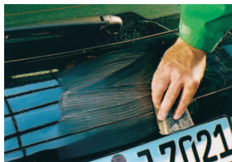
An 14 Karosserie-Stellen wurde Testschmutz aufgebracht: Was bleibt nach der Wäsche davon noch übrig?
